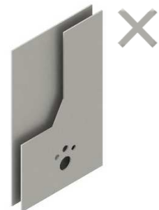
Yere montaj çift taraftan alçıpan kaplama uygulaması
